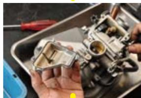
●とはいえバラし始めてみると、フロートチャンバー内は、サビとガソリンが変質したような名ごとな茶褐色に。ちなみにVTZのキャブはケーヒンのVD10型。作業性はいいようだ
