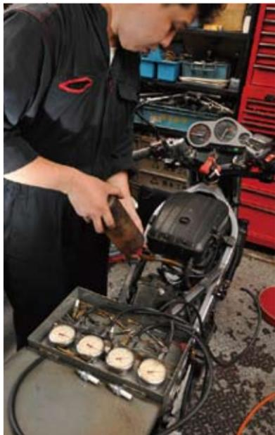
●完調のキャブを再び取り付けエンジン始動。じつに快調！ ちなみにクロスロードさんに今回のキャブ洗浄作業を依頼する場合、作業工賃は2気筒の場合、同調取りまで含め1万5000円、4気筒では同2万円となる
